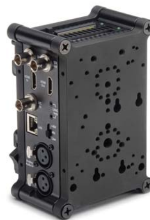
例：2枚のマウントプレートを取り付けた Ki Pro Mini
