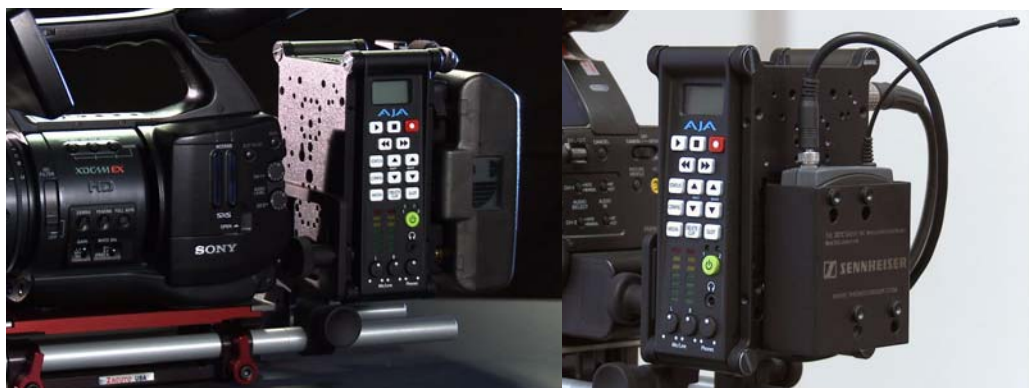
オプションのマウントプレートを使ってカメラにマウントした例
